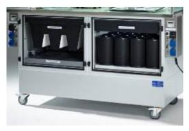
Linke Seite für Feinstäube, Absaugung nach hinten: HEPA-Feinstaubfilter 18m², Klasse H13 mit oder ohne Aktivkohleplatte.
