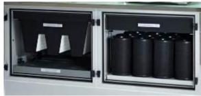
Bei dem Doppelarbeitsplatz können die Filter auf der rechten Seite für geringen Feinstaubanteil und höheren Geruchsanteil eingebaut werden und auf der linken Seite für einen höheren Feinstaubanteil mit geringeren Dämpfen. Die Luftmenge ist getrennt regelbar.
