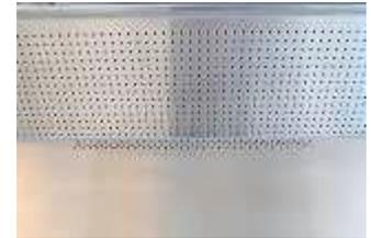
Die Feinstäube werden im Bereich der Arbeitsfläche, innerhalb der Kabine, direkt nach unten abgesaugt.
