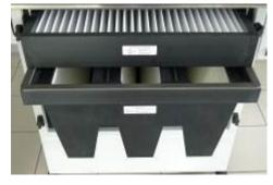
Vorfilter als V-förmige Schublade unterhalb der Arbeitsfläche, für größere Faserpartikel. Die kleineren Faserpartikel von 0,3ym werden zu 99,99% in der HEPA-Kompaktfilterzelle Klasse H13 abgeschieden.
